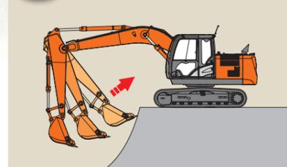
ブーム上げ時、ブームシリンダからの圧油をアーム動作に再利用します。圧力が高められたブームシリンダからの圧油がアーム引き動作に活用されることで、アーム引きのスピードアップと燃費の低減を実現します。
