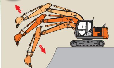
ブーム下げ時にフロントの自重を利用して圧油をブーム回路内で循環(再生)させます。ポンプからの圧油を集中的にアーム動作に利用することができます。これによりアーム/ブーム下げ複合動作のスピードアップと燃費の低減を実現します。
