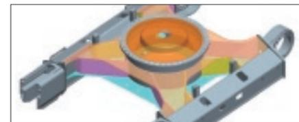
カーボディは、3次元CADシステムと解析プログラムにより設計された箱形断面構造のスパイダータイプ。荷重分散もスムーズな高信頼の足回り構造に仕上げられています。
